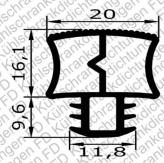
Bestell-Nr. 51060 Steckdichtung ohne Magnet Hinweis: Dichtungsprofile und Dichtungsrahmen mit/ohne Magneteinlage stellen im Sinne des §5, Abs.1, Nr.1 des Deutschen Lebensmittel- und Bedarfsgegenständegesetzes (LMBG) keine Bedarfsgegenstände dar, da sie bei bestimmungsmäßen Gebrauch nicht direkt mit Lebensmitteln in Berührung kommen.
